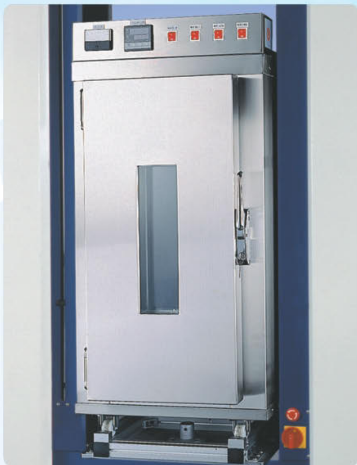
A/B/C Type 高低溫試驗箱 (HT-8747) 本裝置適用於 HT-2402 型系列拉力機
